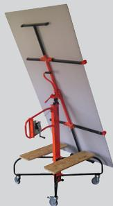
Chargement d'une plaque de 1,20 m x 2,50 m en vue d'une pose horizontale.
