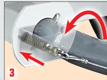
Dispositif d'attelage "Sécurit" breveté. Homologué par l'UTAC suivant le règlement 55 de la CEE-ONU - **Brevet ALTRAD**.
