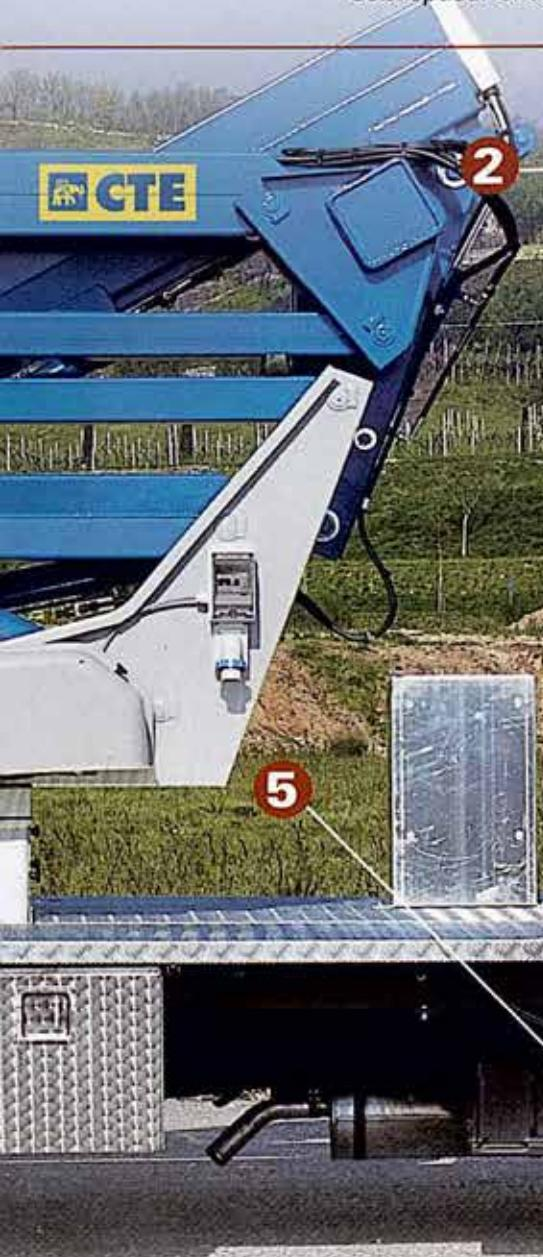
**D** Verkleidete Stützbeine für Stoßschutzung erlauben LKW Nivellierung auf alle Bodenfläche.
