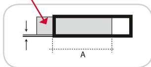
Jeu réduit grâce à une grande longueur de recouvrement (A)
