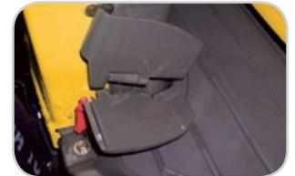
Pédale PTO et pédale d'orientation de la flèche avec capots de protection rétractables afin d'éviter les risques de mouvements intempestifs.
