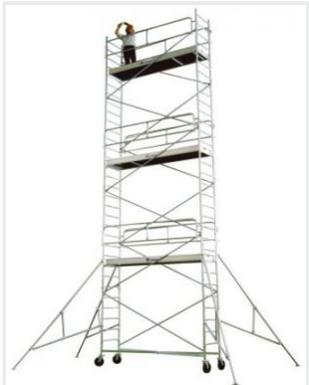
Le Generis 950 est un échafaudage roulant en acier galvanisé avec un plancher de 290 x 67 cm, lui procurant une très grande stabilité. Il sera particulièrement adapté pour une utilisation en extérieur. Ses roues de 200 mm réglables permettent un ajustement sur tout type de surface. Sa base pliante, ses garde-corps monobloc et ses planchers bacs permettent une mise en place très rapide en sécurité. Il dispose de la norme NF avec une hauteur de travail maximum de 14 mètres.
